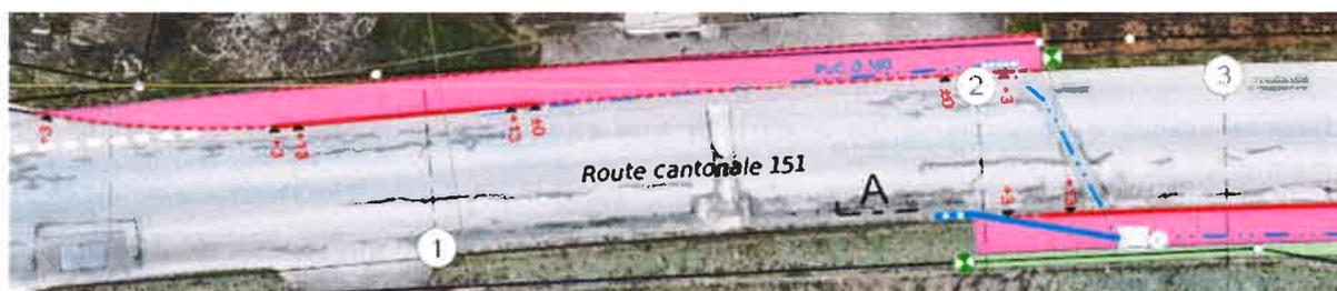
Le système d'évacuation des eaux de chaussée sera adapté, via la pose de trois caniveaux, le long du trottoir.
